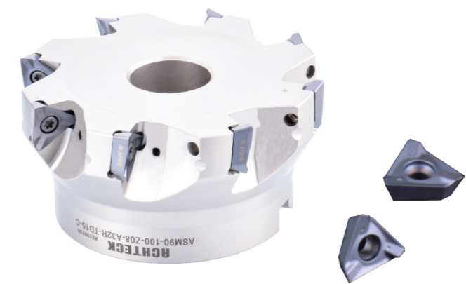
应用：型腔粗加工 解决方案：TDMT 1505...系列 ➢ 正型三刃90°方肩刀片 ➢ 正前角带螺旋角设计,切削轻快 ➢ M级和H级刀片配置,可用于粗、半精、精加工
